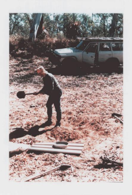
PHOTO 5. COLLECTING SAMPLE FROM STREAM TRAP 40 KG — 4MM.
